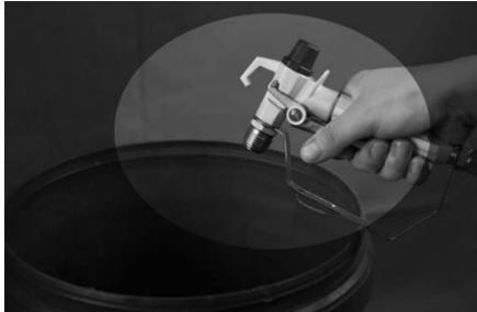
5. Vrid huvudventilen nedåt för att öppna tömningsventilen och låt spolvätskan cirkulera i 15 sekunder för att rengöra tömningsröret.
