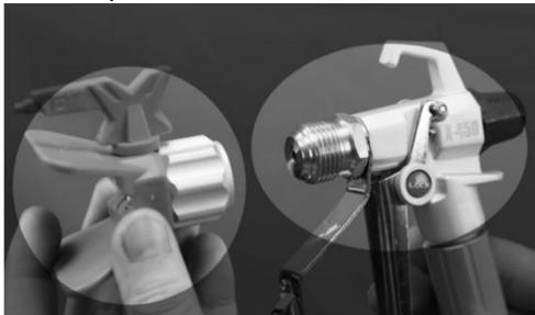
2. Skruva av slangen och anslut den andra änden till pistolen. Använd två skiftnycklar för att dra åt ordentligt.
