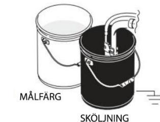
10. Om du sköljer med vatten, skölj igen med mineralsprit eller ett pumpskyddsmedel för att bilda ett skyddande skikt som förhindrar frysning och korrosion.
