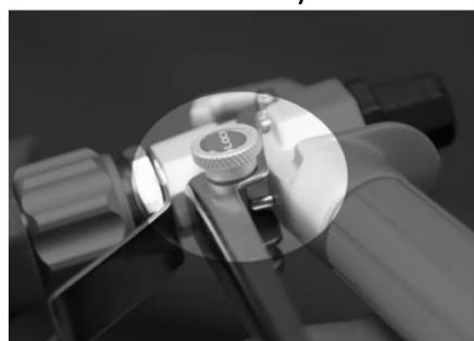
**OBS:** Låt prime/sprutningsventilen vara i PRIME-läget tills du är redo att spruta igen.
