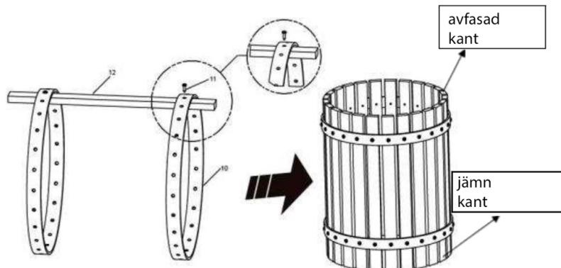
2. Klämplattan av trä (5) och klämplattan av metall (4) hopsätts med skruvar (11).
