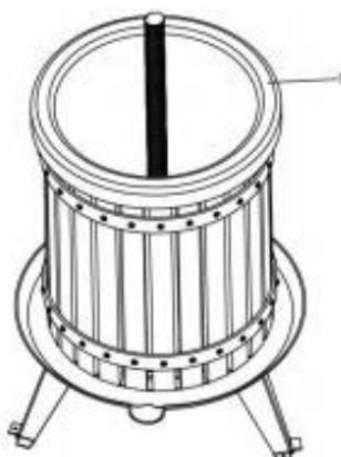
6. Placera halvskivan (7) ovanpå frukten, se till att den är i mitten av tunnan, lägg sedan till tröklossarna (6) (om det finns tillräckligt med utrymme) och sedan klämplattenheten (4 och 5) ovanpå dem, så att den korsar träplattorna i längdrikningen.
