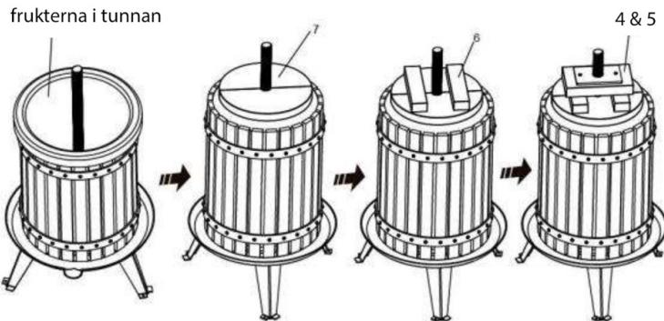
7. Placera nylonbrickan (3) på klämplattenheten enligt bilden. Skruva på ledaxeln (2), tryck på handtaget till ledaxeln och vrid handtaget (1) nedåt för att pressa in frukten i cylindern.
